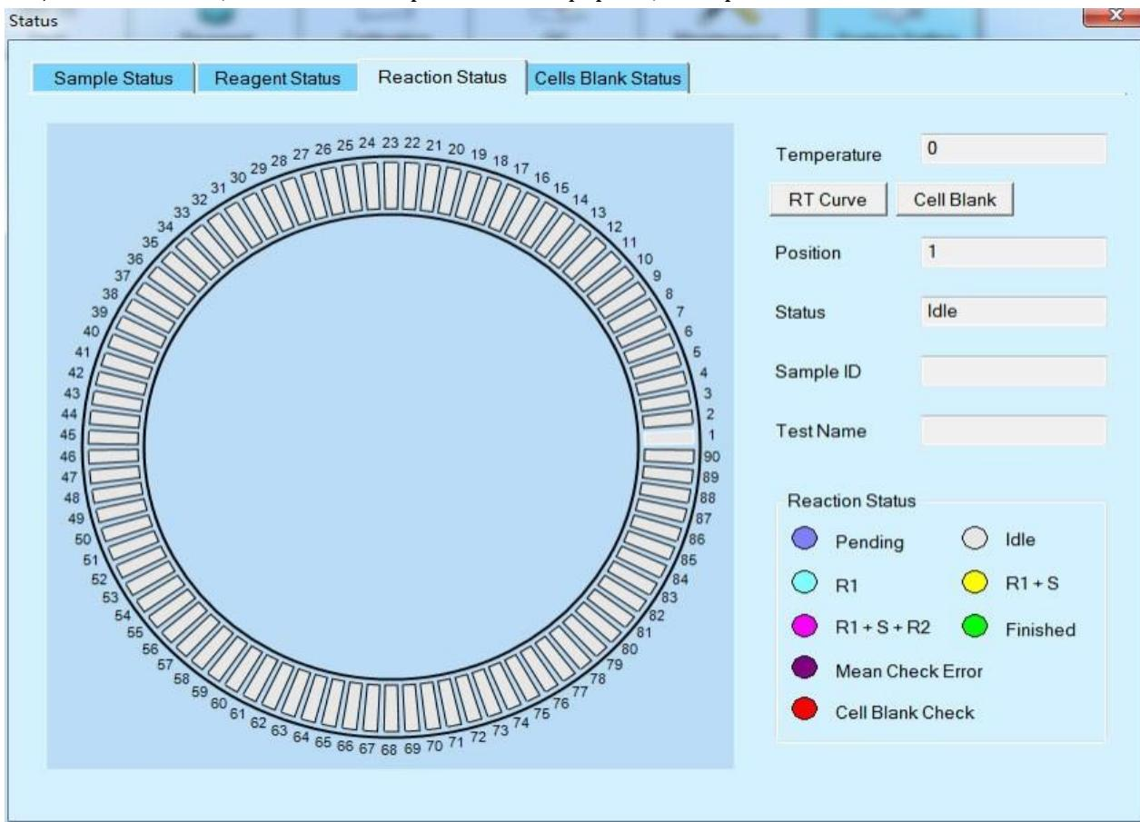
**Температура:** Отображение температуры реакционной таблицы в режиме реального времени.
