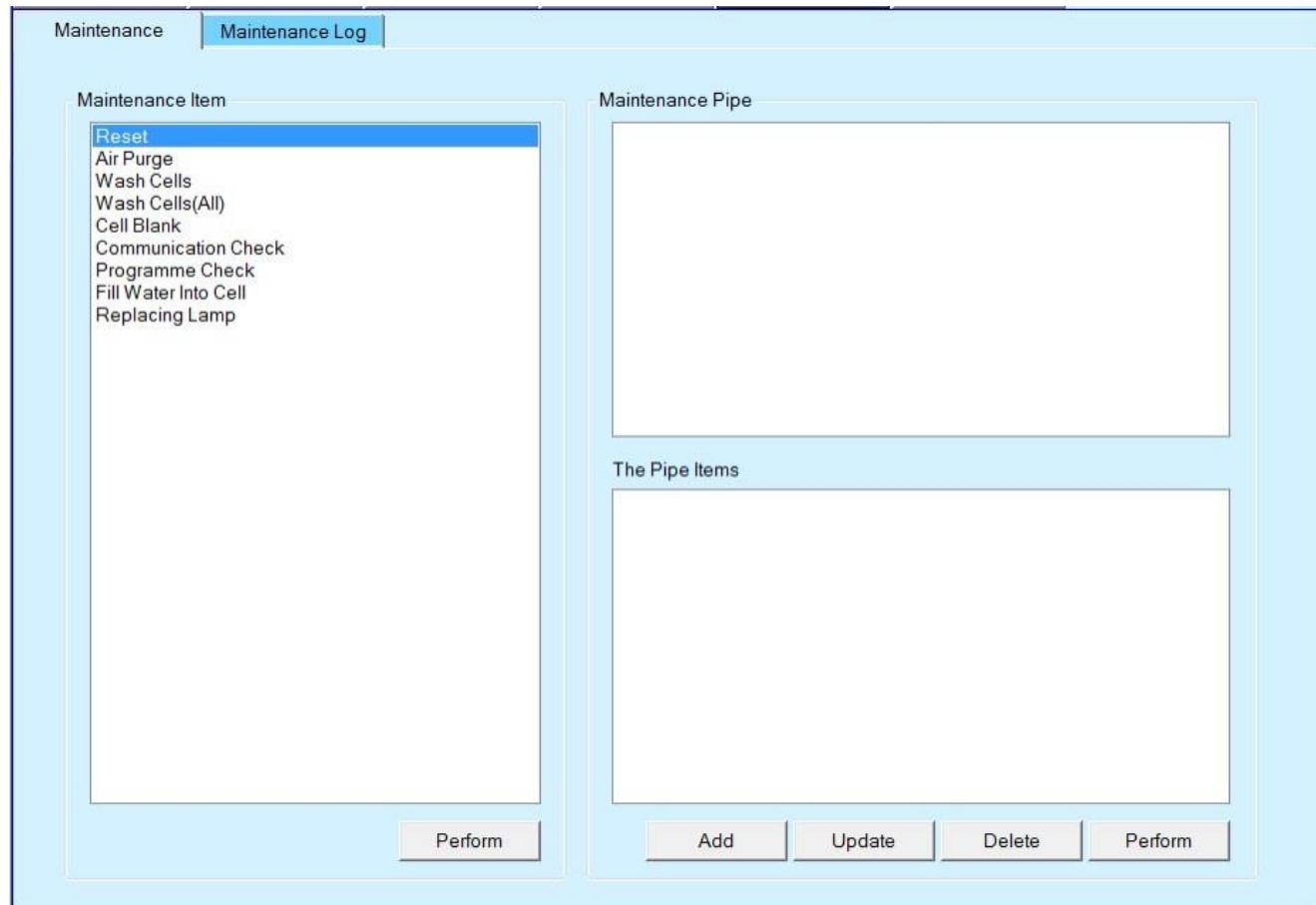
**Узел обслуживания:** отображается список действий по обслуживанию узлов прибора.
